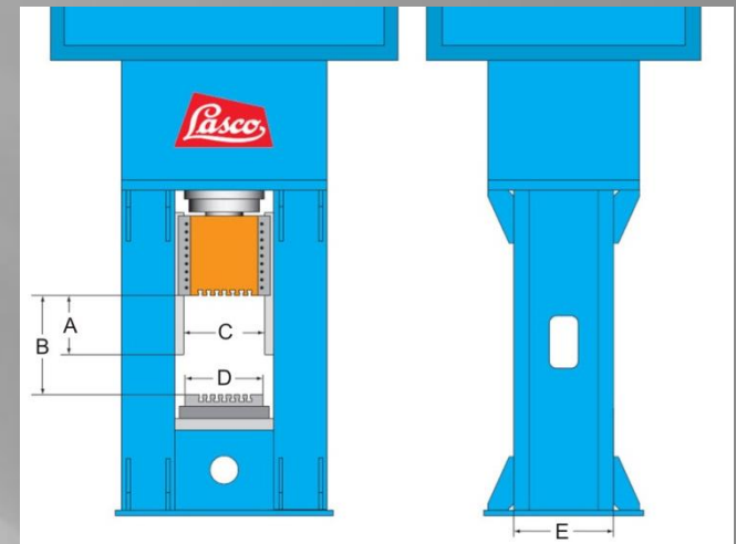
Slika 2.2 Dimenzije radnog prostora prese ( Lasco VP, 47,60 ) A - hod pritiskivača, B - maksimalna instalaciona visina, C - razmak između vođica, D - širina stola, E - dužina stola
